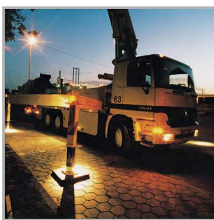
Фонари для освещения 4 выдвижных опор повышают безопасность и скорость развертывания оборудования в темноте.
