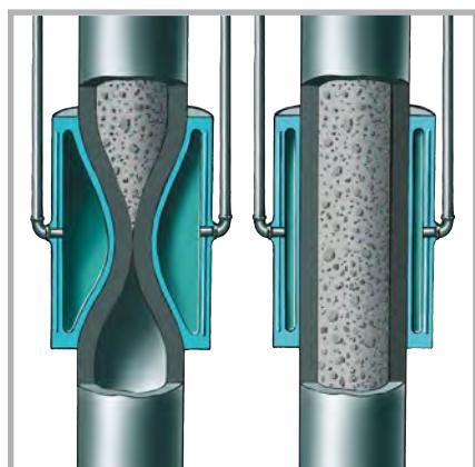
Пневматическая зажимная муфта для концевого шланга (EQV) прерывает подачу бетона, позволяет избежать подтекания бетонной смеси при перемещении стрелы от одного места укладки к другому.
