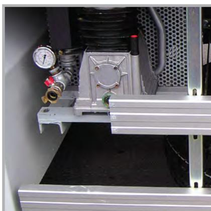
Доступный по цене компрессор с производительностью 455 л/мин, развивающий давление 12 бар – благодаря своим компактным размерам монтируется за боковым противоподкатным бруском.
