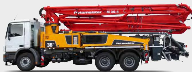
Вес- до 24 тонн: Допускается для проезда по дорогам общего пользования РФ, не требуется получение специального разрешения.
