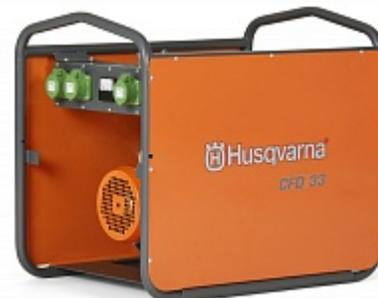
Подбор правильного вибратора осуществляется по принципу суммарного потребляемого тока вибраторами, он не должен превышать вырабатываемый преобразователем выходной ток. К примеру: CF25 вырабатывает ток в 25 А, следовательно он может питать два вибратора AX48, каждому из которых требуется 10А.
